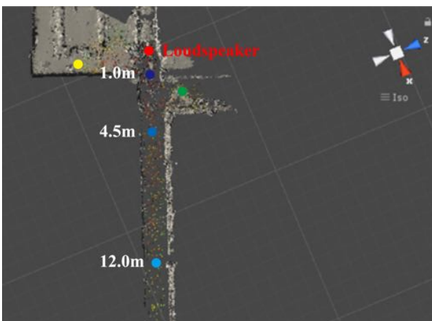
図-4 計測場所の空間マッピング結果とスピーカ配置
