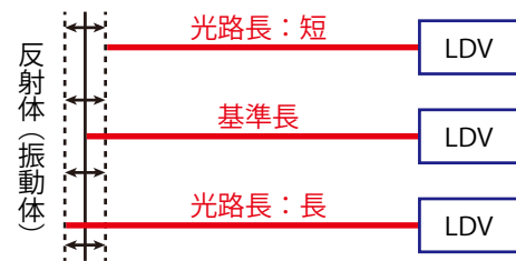
図 2 レーザドプラ振動計 (LDV) による振動速度計測。LDV から放射されたレーザー光が振動体に反射され LDV 内に戻るとき、振動体の変位に応じて光路長が変化する。光の位相は光路長に依存するので、反射して返ってきた光の位相を復調することで振動体のレーザー経路方向の振動速度を得ることができる。
